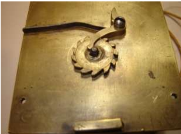
View: Barrel Ratchet, Click, Click-Spring. "Il sistema di arresto di carica"
