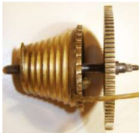
Main-wheel G1. La ruota del conoide (z = 96)"
